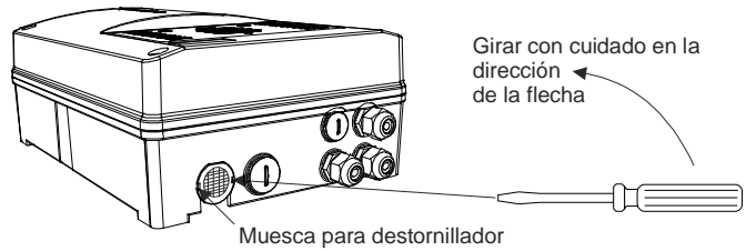
Fig. 20 Retirada del tapón de tubo de la salida de aire
